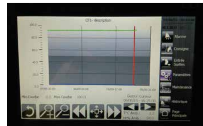
L'HD Cold permet de maintenir une température de 1°C (en bleu) et une hygrométrie de 94 % (en vert) constantes pendant 24 heures.
